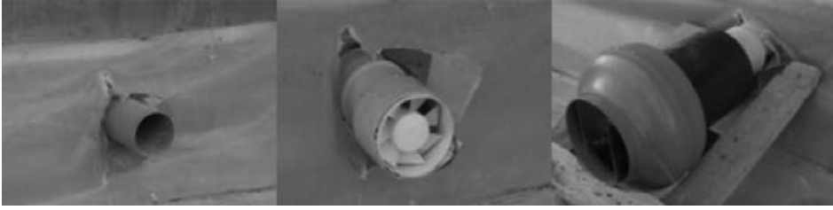
Şekil 1. Araştırmada kullanılan farklı kapasitedeki fanların görüntüsü. Solda: 95 m 3 /h Ortada: 305 m 3 /h Sağda: 990 m 3 /h
